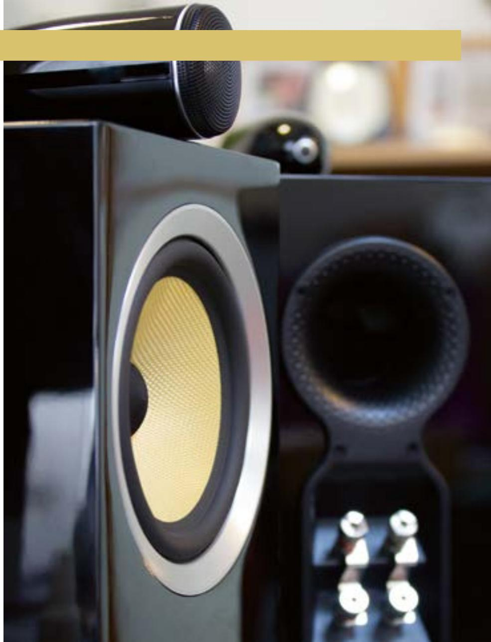
selon la technique du bass-reflex. La réponse utile s'étend ainsi jusqu'à 45Hz environ. Ce haut-parleur dont la membrane en Kevlar se déforme peu, vaut par sa rapidité et la faible distorsion du signal émis. L'évent FlowPort garantit quant à lui un écoulement d'air régulier et silencieux, notamment à fort volume d'écoute. Touche de raffinement : le saladier du haut-parleur ne laisse apparaître aucune vis de fixation.
