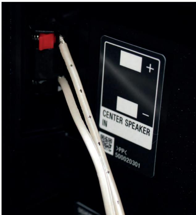
*Un bornier permet de relier le Sony XR-65A90J à la sortie de l'enceinte centrale d'un ampli home-cinéma. La dalle en verre de l'écran se charge alors de diffuser les dialogues.*
