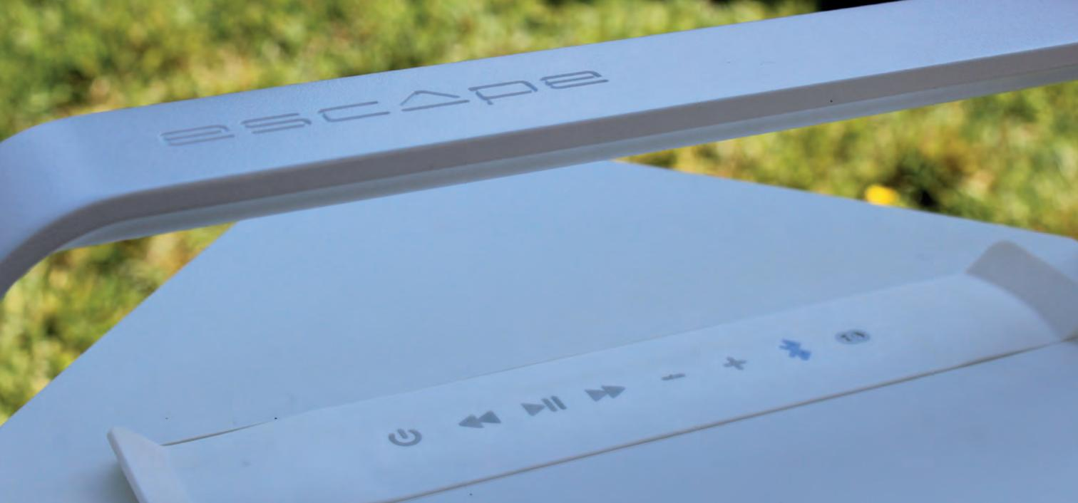
*L'interface de commande de l'enceinte Escape P9 permet de la mettre en marche ou en veille, de contrôler les principales fonctions de lecture audio (lecture/pause, titre suivant/précédent, volume +/-) et d'effectuer l'appairage Bluetooth.*
