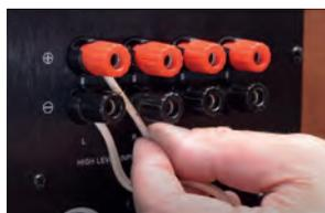
Brancher un caisson de basses (sortie ampli haut niveau, en parallèle)
