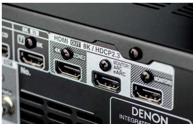
*L'ampli home-cinéma Denon AVC-X4700H dispose d'une sortie HDMI compatible ARC et eARC.*
