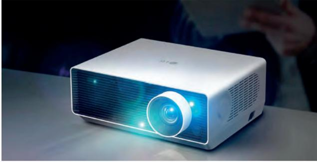
*La lampe laser du vidéoprojecteur UHD-4K LG BU50NST offre une luminosité maximale de 5000 lumens. Sa durée de vie est estimée à 20000h au moins.*
