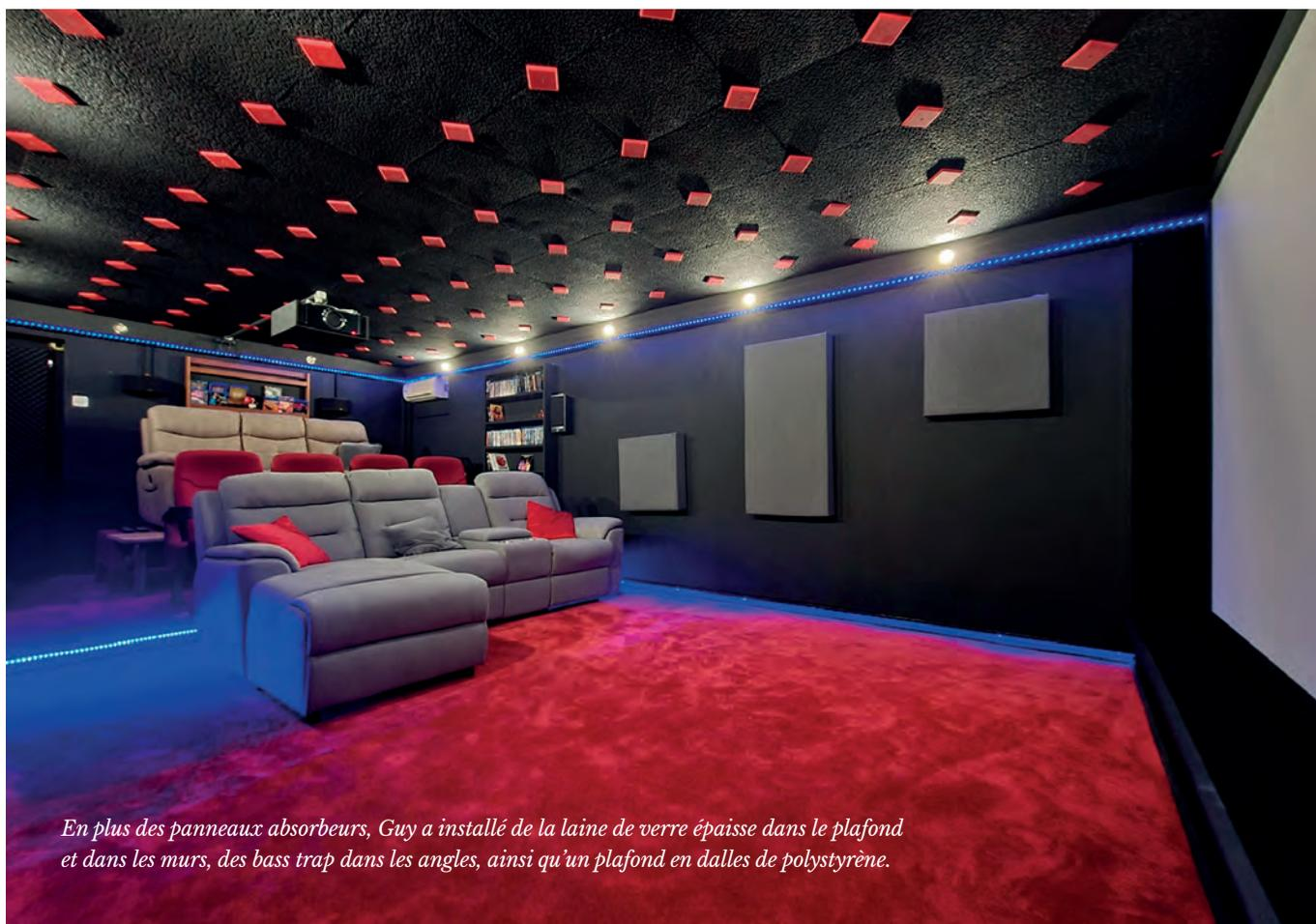
*En plus des panneaux absorbeurs, Guy a installé de la laine de verre épaisse dans le plafond et dans les murs, des bass trap dans les angles, ainsi qu'un plafond en dalles de polystyrène.*
