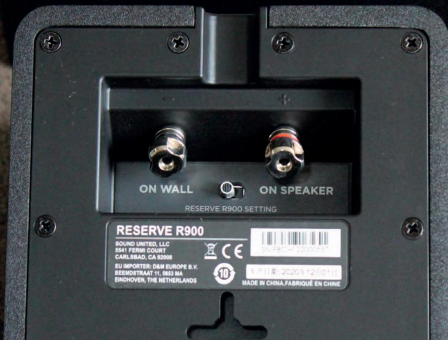
*Sous le bornier de l'enceinte Dolby Atmos Polk R900 se trouve un commutateur permettant de choisir son mode de fonctionnement (sur le mur ou sur une colonne) et d'adapter sa courbe de réponse en conséquence.*
