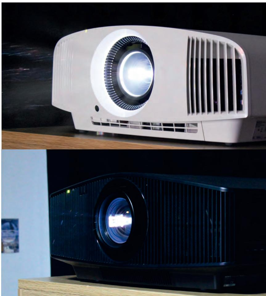
*Les objectifs des Sony VPL-VW290ES (en haut) et VPL-VW890ES (en bas) utilisent des lentilles de grand diamètre réalisées dans un verre optique qui garantit l'uniformité de la luminosité sur toute la surface de l'écran.*
