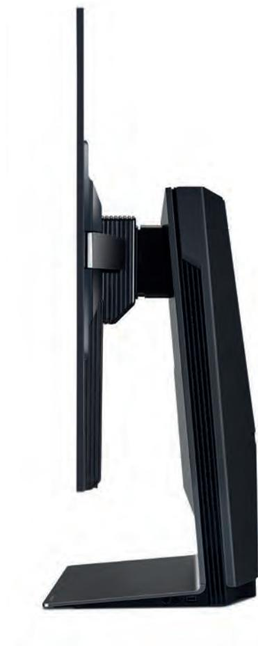
En forme de L, le pied du LG 42LX3 intègre le système mécanique de courbure de l'écran ainsi que l'électronique et la connectique.
